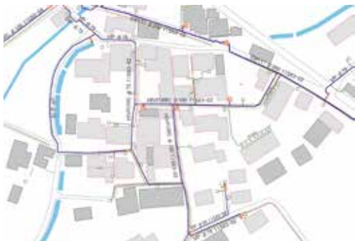
水道管管理システム画面 (水道管の布設位置や口径等を管理)
